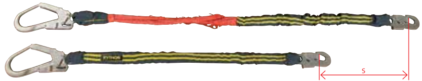
Kleine Auffangstrecke (Bremsweg s) durch effiziente Falldämpfung (Normsturz 100,0 kg, Sturzfaktor 2,0)
